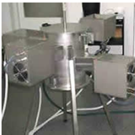
Rys. nr 1. Reaktor ATON 2 przeznaczony do utylizacji niewielkich ilości odpadów szczególnie niebezpiecznych
